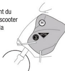
**3** Attachez les crochets des courroies 2 sous le scooter directement ou avec l'aide de l'extension 4, si c'est nécessaire.
