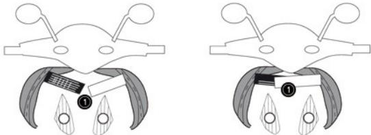
**4** Passez la sangle 3 sur l'avant du scooter, insérez le "nez" du scooter dans la bride M et attachez la sangle 3 au tablier.
